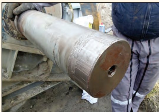
Détail de l'arbre monté par frettage : usure par petits débattements.
